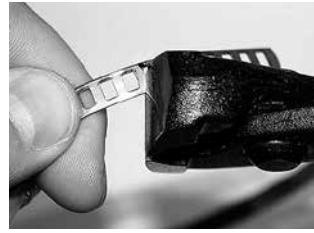
Adım 3 Malzemenin geri kalan kısmını kesin. Olası yaralanmaları önlemek için bir eğe ile kesilen kenarların çapaklarını alın.
