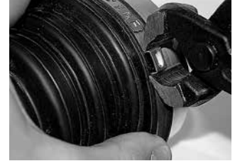
Adım 4 Keleççeyi nesnenin üzerine yerleştirin. Kilitleme kancalarını en sıkı pencere konumunda kilitleyin. Kulağı Oetiker kerpetenleri ile kuvvetlice sıkıştırın.
