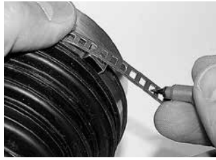
Adım 2 Keleççe uzunluğunu belirleyin. Keleççe ucunun şekilde gösterildiği gibi "kulağı" atladığından emin olun.
