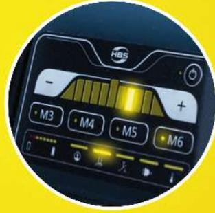
Kolay kullanılan ve parametre değiştirilen düğmeler sayesinde herkesin kullanabileceği basit uygulama. +/- tuşları sayesinde ince ayar yapabilmek. Değişiklikleri otomatik kaydetme
